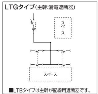
**単3** 主幹：単3中性線欠相保護付 漏電遮断器・配線用遮断器 送りスペース付 下部スペース(400mm)付
