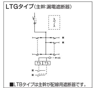
**単3** 主幹：単3中性線欠相保護付 漏電遮断器・配線用遮断器 送りスペース付 自動点滅回路付 タイムスイッチ(×2)付
