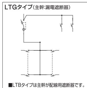
**単3** 主幹：単3中性線欠相保護付 漏電遮断器・配線用遮断器 非常回路(×2)付 (※送りスペースなし)
