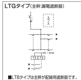
**単3** 主幹：単3中性線欠相保護付 漏電遮断器・配線用遮断器 送りスペース付 自動点滅回路付 タイムスイッチ(×2)付
