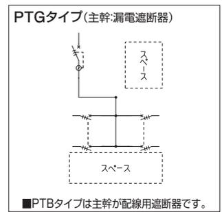
**3相** 主幹：漏電遮断器・配線用遮断器 送りスペース付 下部スペース(600mm)付
