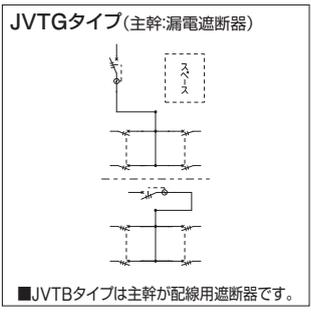
**電灯/単3 動力/3相** 主幹：漏電遮断器・配線用遮断器 (電灯回路：単3中性線欠相保護付) 送りスペース付(電灯のみ)
