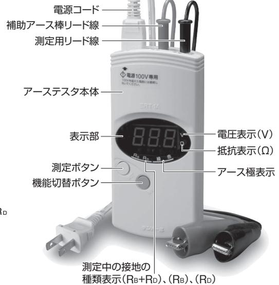
近年、接地抵抗の測定は、都市化による舗装で、測定に使用する補助アース棒の打ち込み場所や十分な距離での打ち込み場所がないなどの制約が多く、接地が施設された機器でも接地抵抗の測定において電気安全の管理に課題があります。
