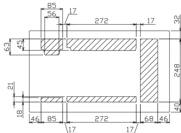
配線孔寸法図(//部開口)
