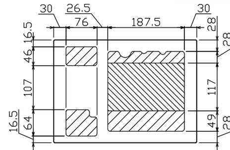
配線孔寸法図(//部開口, \\\部分岐背面)
