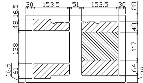
配線孔寸法図(\\部開口, \\部分岐背面)
