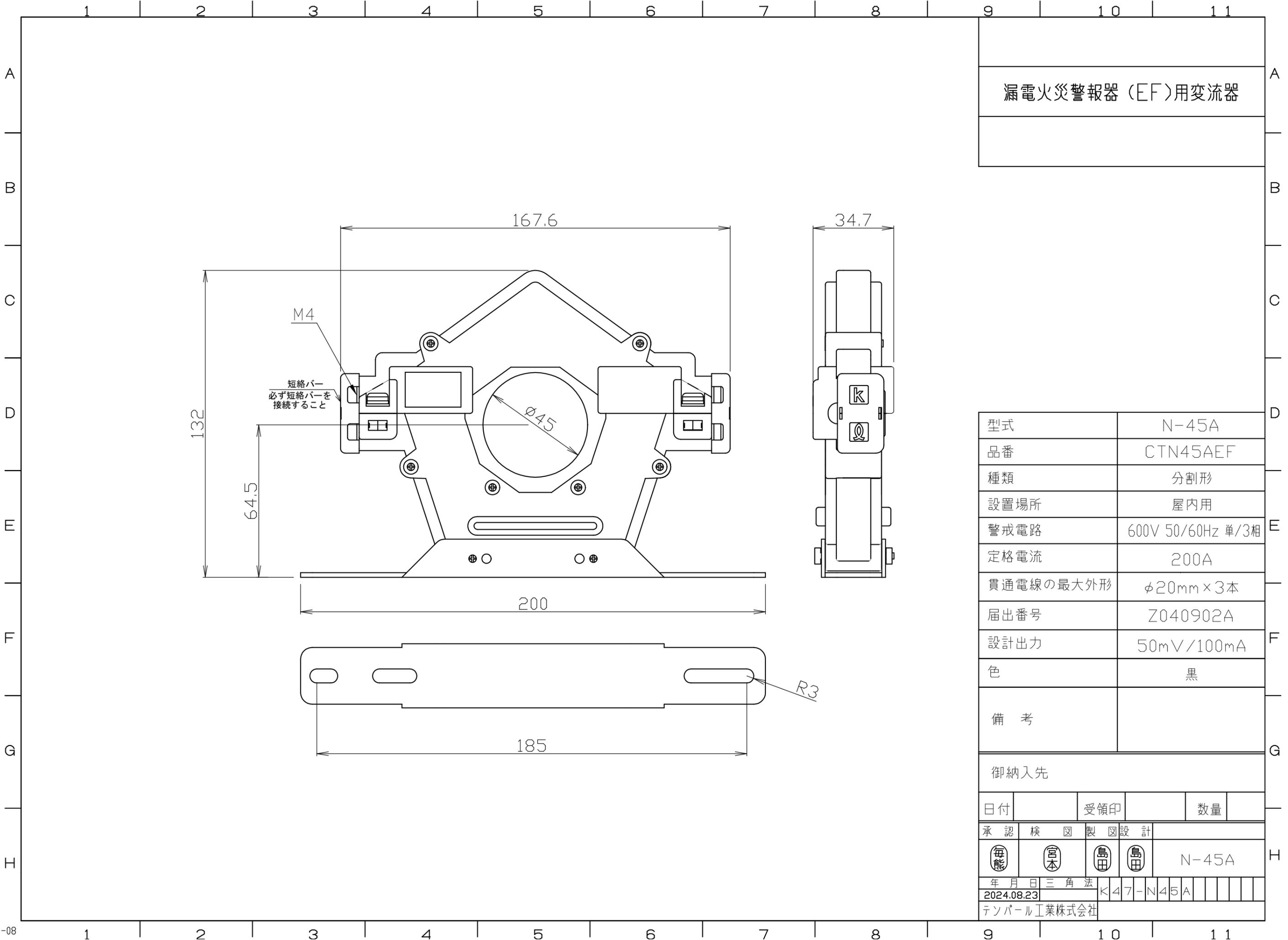
漏電火災警報器 (EF) 用変流器
